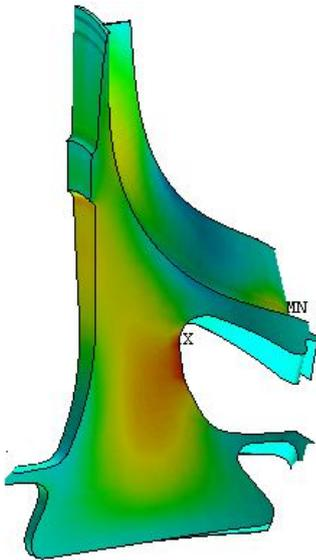
Рис. 2. Зона максимальных напряжений при НДС реальной детали
