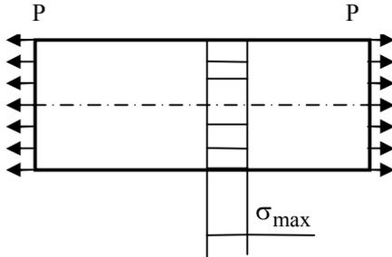
Рис. 1. Растяжение гладкого образца при испытании на МЦУ
