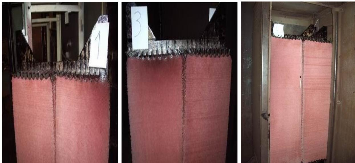
Рис. 4. Окраска сотовых панелей до высокотемпературной обработки
