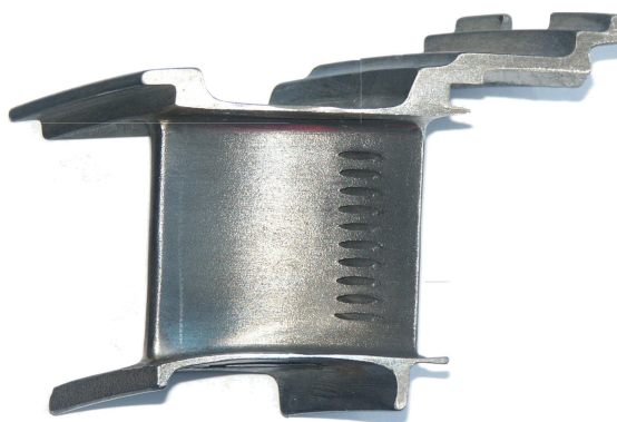
Рис. 1. Исходная конструкция (внешний вид) лопатки СА (внешний вид)
