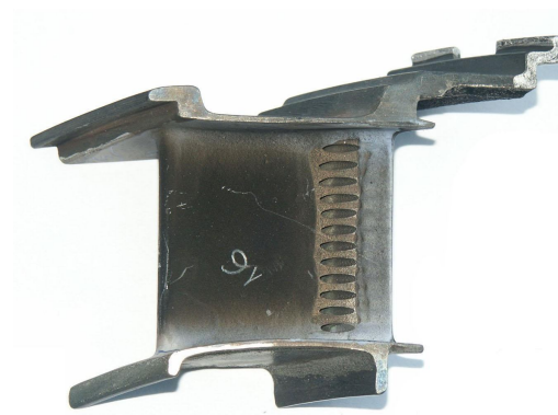
Рис. 2. Модернизированная конструкция лопатки СА
