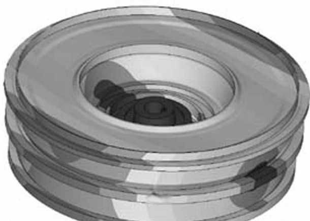
Рис. 1. Преимущественно изгибные колебания с одним узловым диаметром, f = 134 Гц
