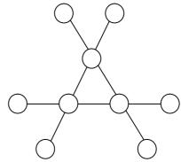
Рис. 5. Радиально – кольцевая структура первого типа
