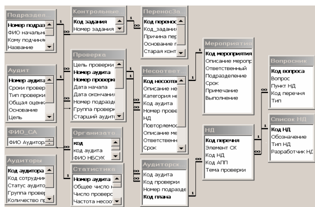
Рис. 3. Схема данных в MS Access для базы данных аудитов
