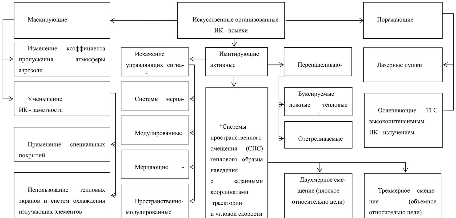
Рис. 1. Классификация систем защиты ЛА на базе искусственных организованных ИК - помех
